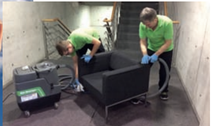
DIE TECHNIK MACHT ES: Der Bio-Sprüh-Sauger erreicht mit seiner schonenden Kapillarwirkweise selbst tiefliegende Polsterschichten.
