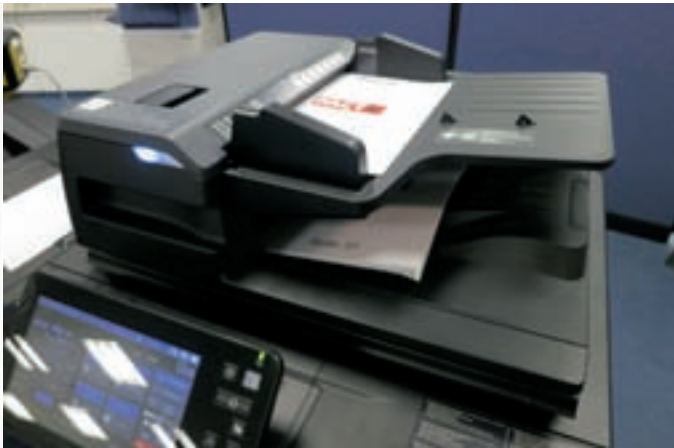
RASEND SCHNELL: Der Hochleistungsscanner ist in der Lage, je nach eingestellter Auflösung bis zu 240 Bilder in der Minute zu erstellen.
